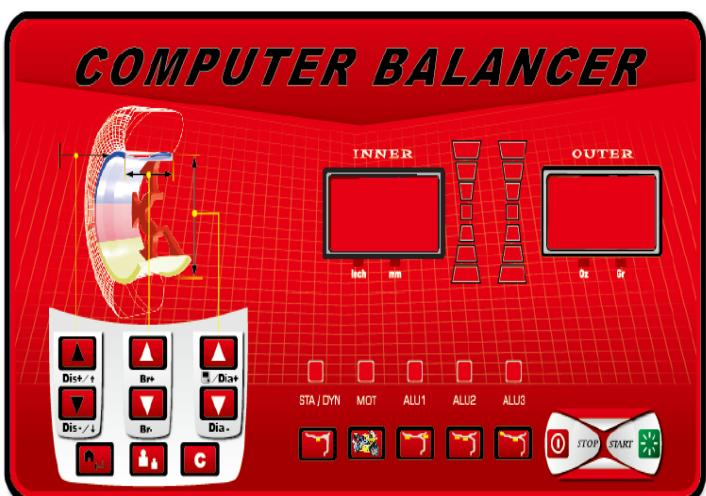
1. В режиме ввода параметров колеса нажатие на эту кнопку позволяет ввести **ВЫЛЕТ** колеса. Изменить параметр **Dis** вы можете, нажимая на +/-.
