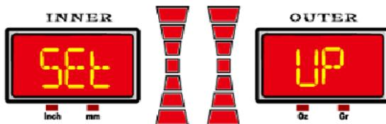
Нажмите для входа в режим настройки специальных функций. Отображаются пары значений для выбора: "IN"- "TES" и "CAL" - "CAL".
