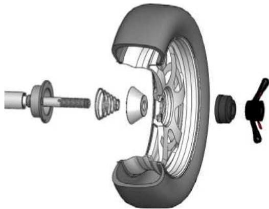
Балансировочный вал → пружина → подходящий конус → колесо → проставочное кольцо → гайка.
