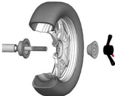
Балансировочный вал → колесо (внешняя сторона колеса устанавливается наружу) → конус → гайка.
