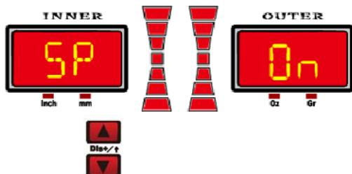
Выберите для настройки включения и выключения функции управления защитной крышкой.
