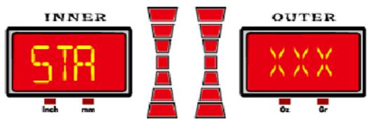
В режиме **DYN** нажмите на пьезоэлектрический датчик в параллельном направлении по отношению к балансировочному валу. Значение в правом поле увеличится. При отпускании датчика это значение уменьшится. Это означает, что настройка датчика произведена правильно.
