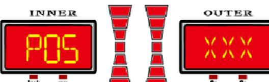
В режиме **STA** нажмите на пьезоэлектрический датчик в вертикальном направлении по отношению к балансировочному валу. Значение в правом поле увеличится. При отпускании датчика это значение уменьшится. Это означает, что настройка датчика произведена правильно.
