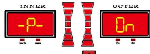
Нажмайте кнопки для настройки включения и выключения защитной крышки.
